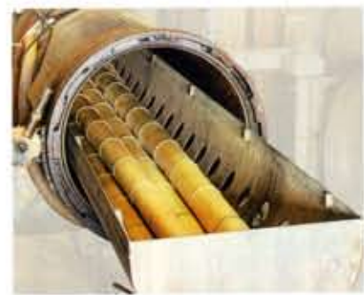
真空加圧式注入機による薬剤浸透で、防虫効果はほぼ100%という
