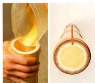
ウレタン樹脂を充填し(写真左)、背割り加工した強化竹(右)
